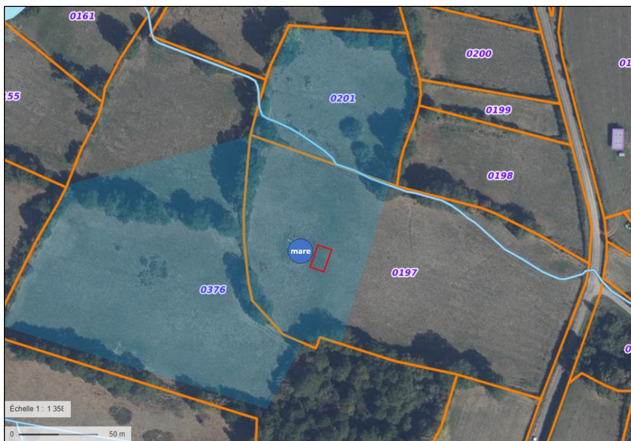
Figure 18. Zone d'implantation (en rouge) du système d'abreuvement par rapport à la mare mise en défens (vue aérienne, Géoportail).
